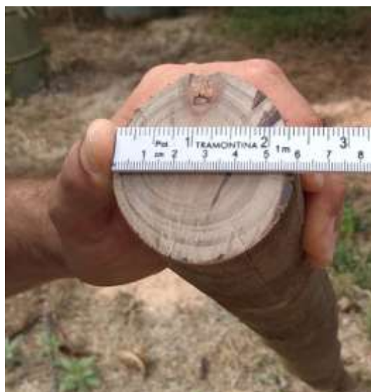
Figura 10: Medida da ponta de uma peça de eucalipto de 6cm de diâmetro
