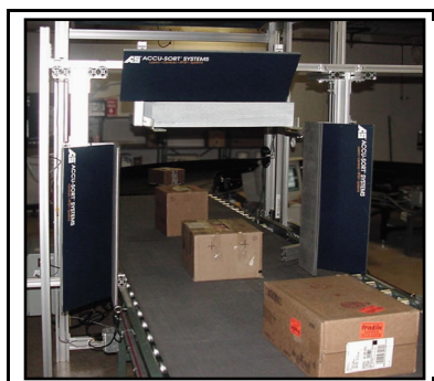
Figura 13– Leitor ou scanner de TAG RFID.
