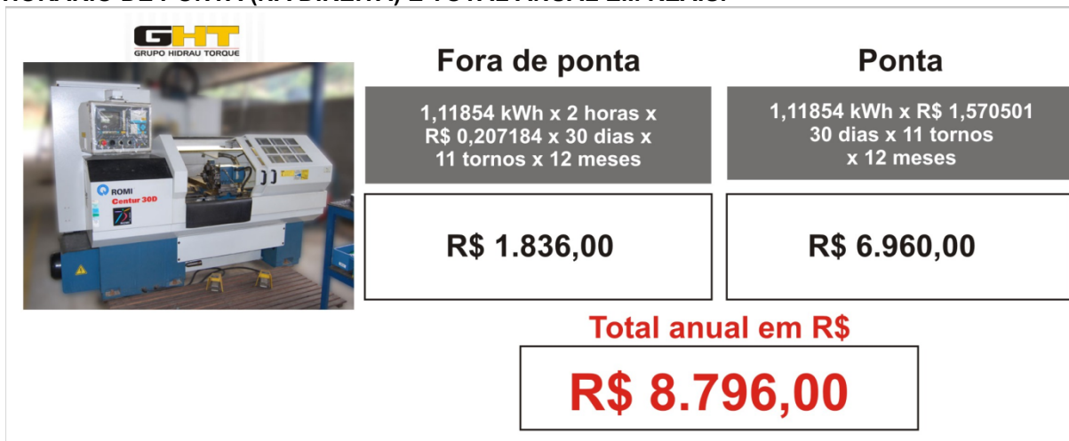
FIGURA 3: CONSUMO FORA DO HORÁRIO DE PONTA (NA ESQUERDA), CONSUMO NO HORÁRIO DE PONTA (NA DIREITA) E TOTAL ANUAL EM REAIS.
