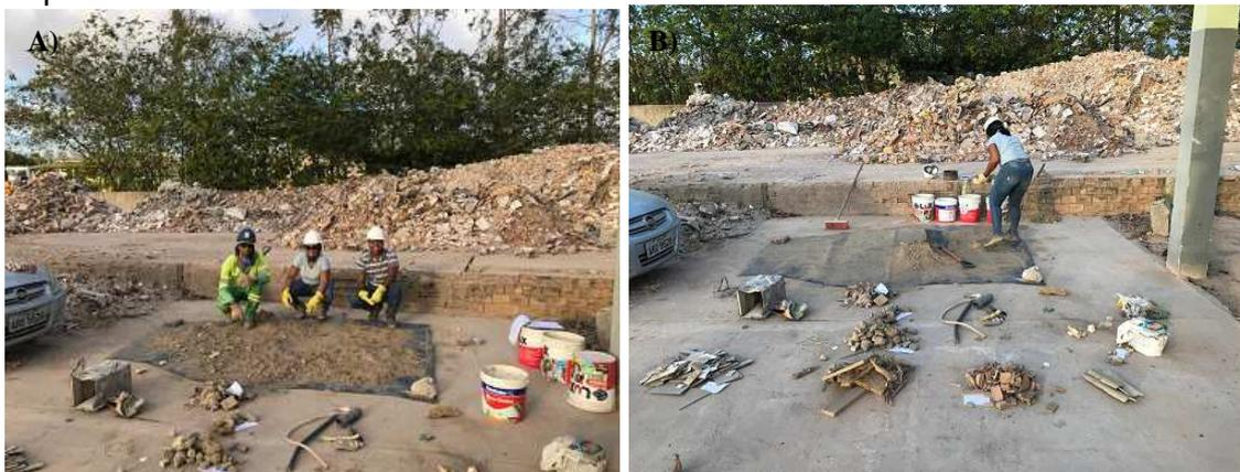
d) Peneiramento por amostra – O peneiramento manual dos restos não identificáveis (Figura 5) foi realizado por meio das peneiras de malha 2,00mm, 0,425mm e 0,075mm, onde respectivamente classificou-se em pedregulho, areia e silte (Figura 3).
