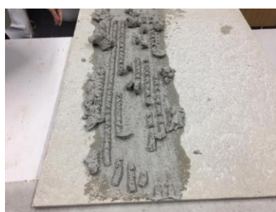
Figura 04 - Tentativa de espalhamento da argamassa tradicional.
