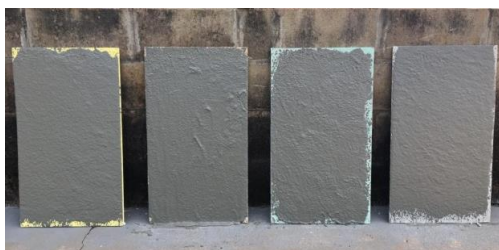
Figura 01 - Chapiscamento dos substratos.
