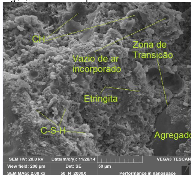
Figura 7 - Microscopia do concreto areia macharia, 50 µm aos 28 dias
