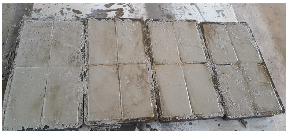
Figura 5– Formas utilizadas para moldagem dos blocos
