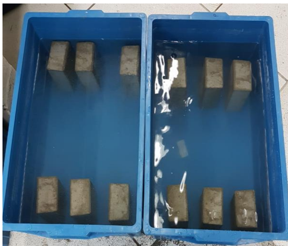
Figura 6 – Reservatório com água para ensaio
