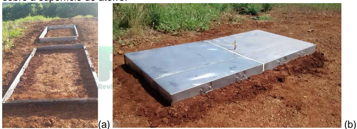
Figura 1: (a) Áreas experimentais (controle e enriquecida) e (b) Câmara de fluxo sobre a superfície do aterro.
