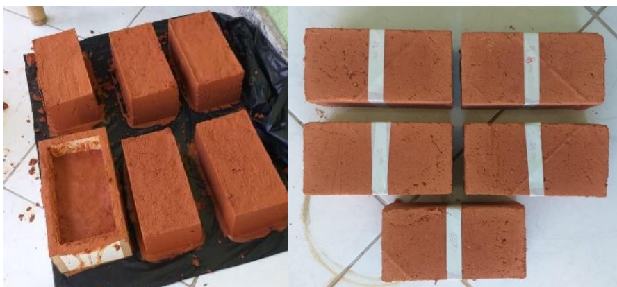
Figura 2: Tijolos Adobe com aditivo, moldes e processo de cura.
