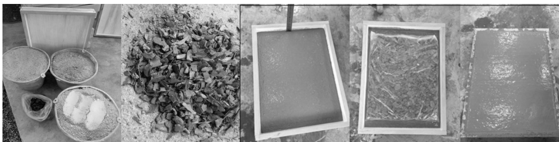
Figura 4 – Execução das Placas de Revestimento para Fachadas.
