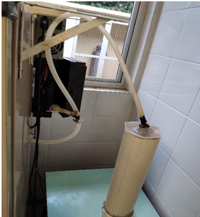
Figura 3. Sistema de coleta e quantificação de biogás
