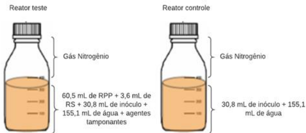
Figura 1 – Composição dos reatores dos testes de BMP com resíduos alimentares
