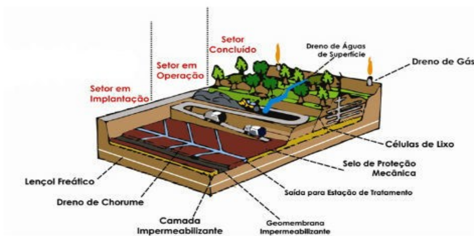
Figura 1 - Estrutura de aterro sanitário
