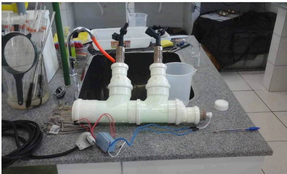
Figura 3 – Fotorreator montado e em operação no laboratório da UERGS
