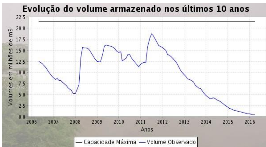
FIGURA 3 - Variação do volume de armazenamento de água do açude várzea Grande entre 2006 e 2016.
