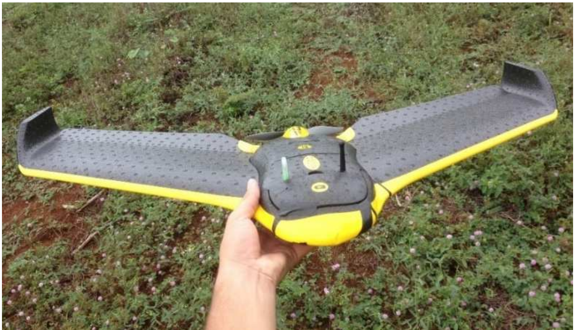
Figura 2 - VANT utilizado na pesquisa - eBee da SenseFly. da área delimitada em plano.
