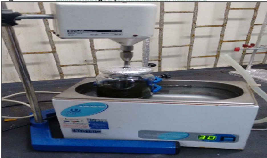
Figura 5 – Sistema de agitação mecânica associado ao banho ultrassônico
