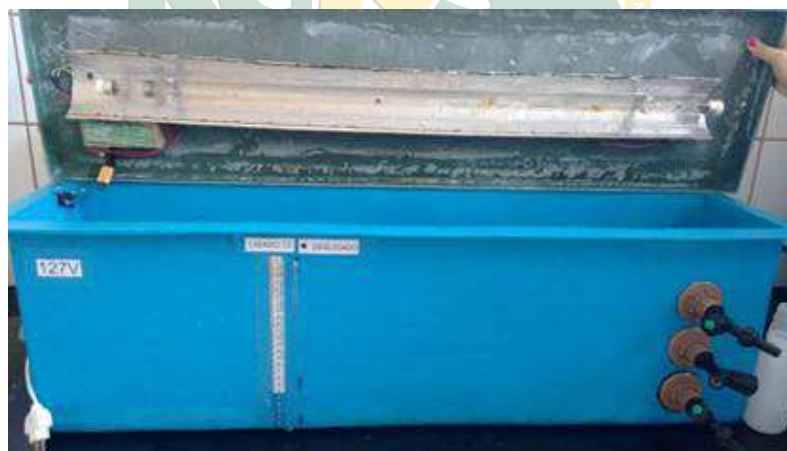
Figura 2 – Detalhe da lâmpada UV e demais instalações do reator
