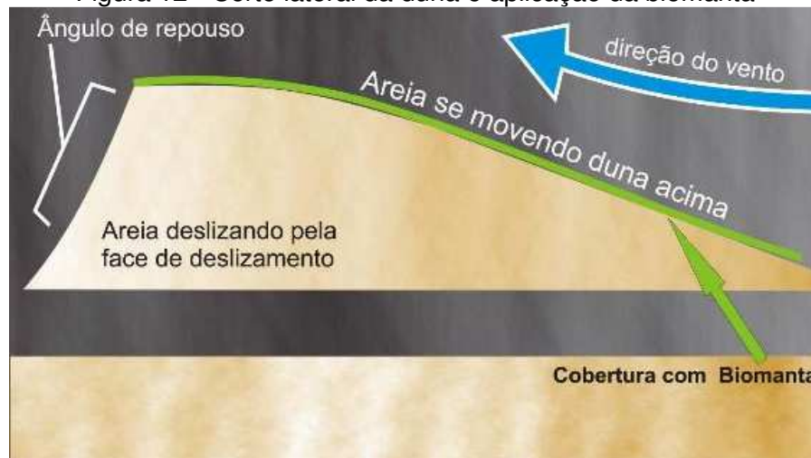
Figura 12 - Corte lateral da duna e aplicação da biomanta
