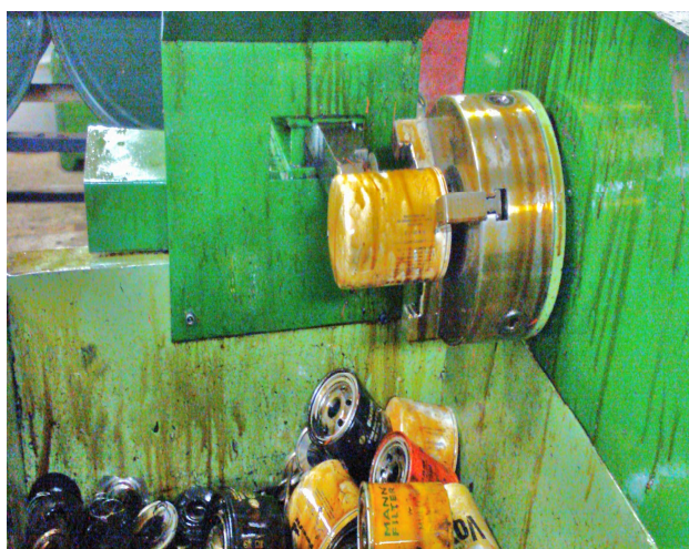
Figura 3 – Torno mecânico que realiza o corte de filtros usados.
