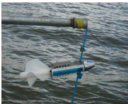
Figura 5 - Mechanical flowmeters usado na determinação da velocidade.
