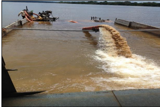
Figura 07: Extração de areia por dragagem (sucção da polpa). Altamira-PA
