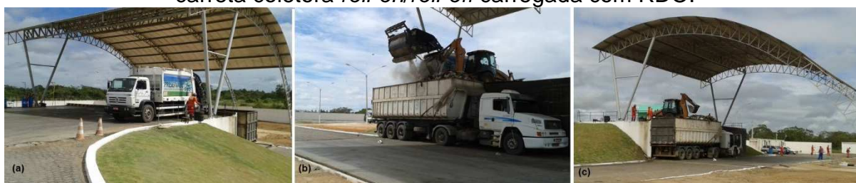
Figura 5 - Processo de transbordo de RDO: (a) descarga de RDO pelo caminhão compactador; (b) acomodação de RDO na carreta coletora pela retroescavadeira; (c) carreta coletora roll-on/roll-off carregada com RDO.
