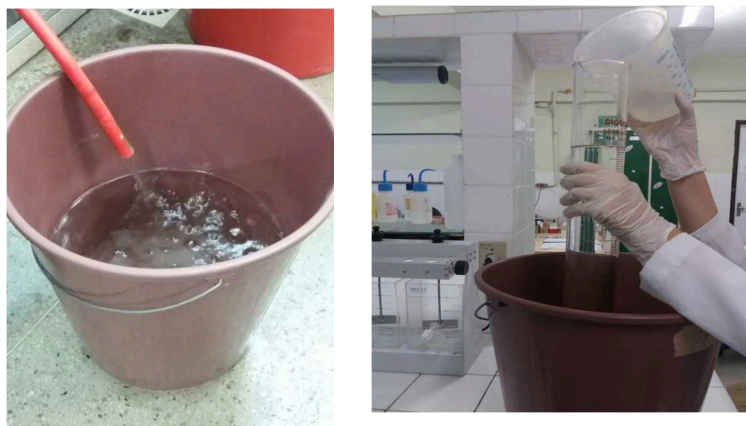
Figura 2: Procedimento de coleta de água para a medição de vazão.
