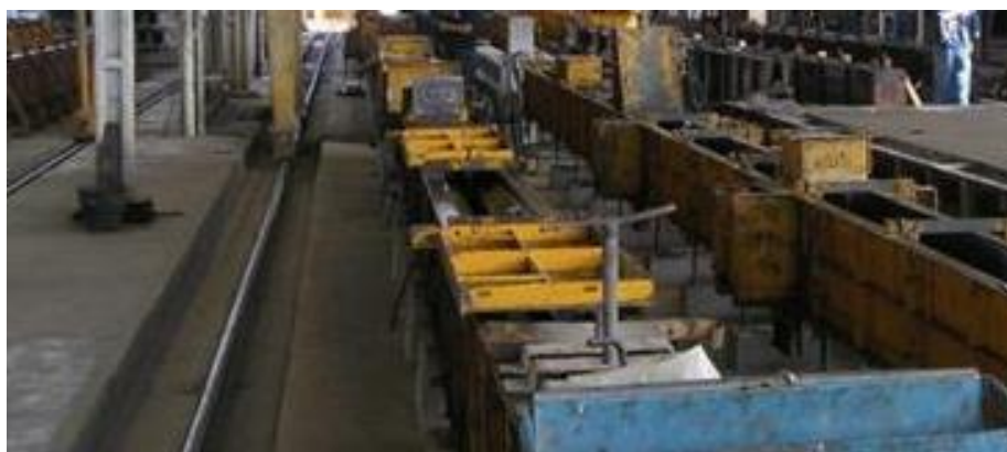
Figura 2: Transporte do concreto até os locais de enchimento das formas
