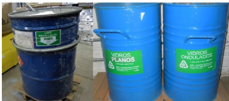
FIGURA 9: Acondicionamento de resíduos de vidro.
