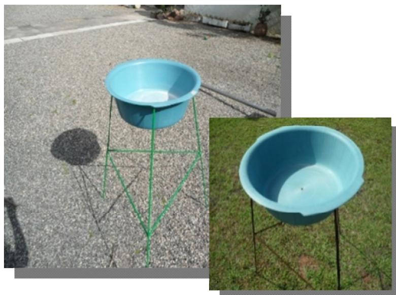
Figura 02- Coletor de amostras de água da chuva.
