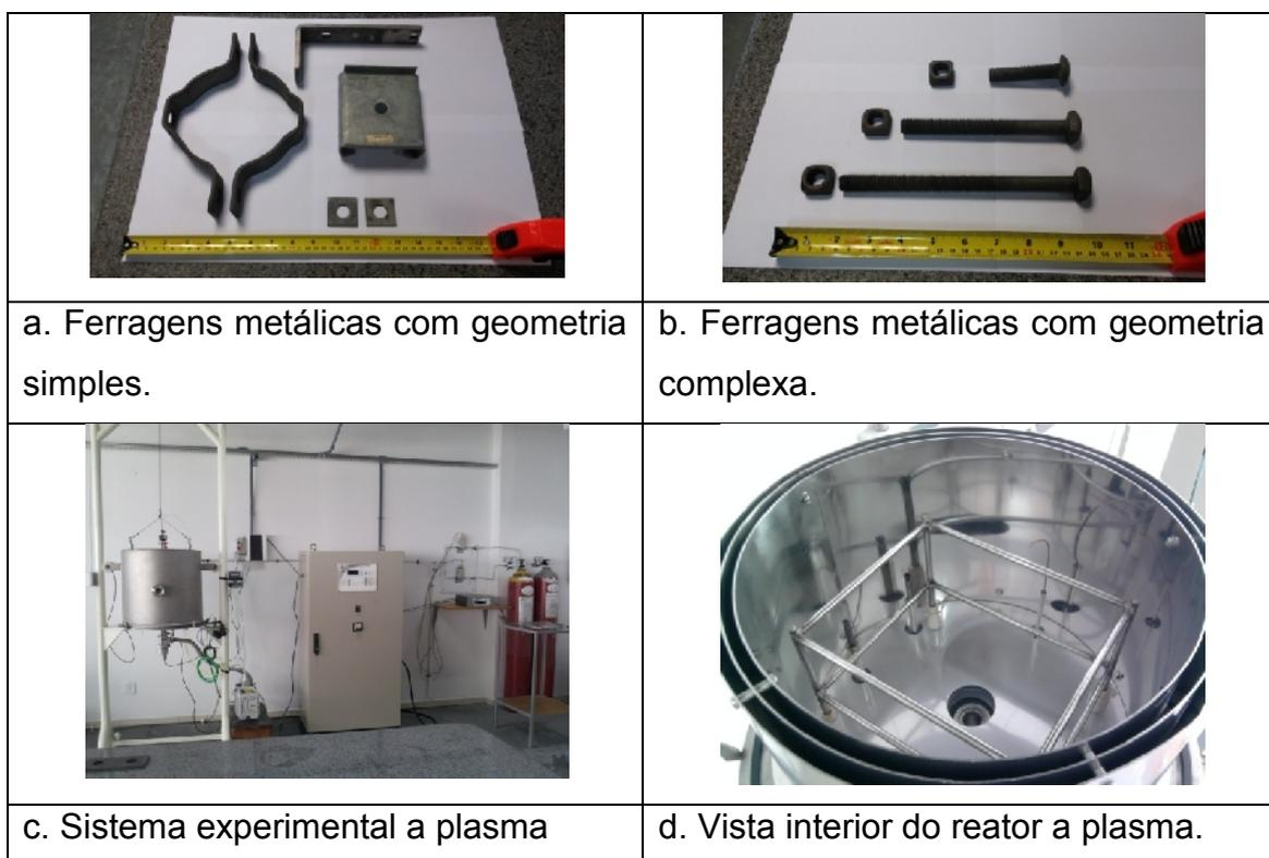
Figura 1 - Sistema experimental a plasma e ferragens metálicas.
