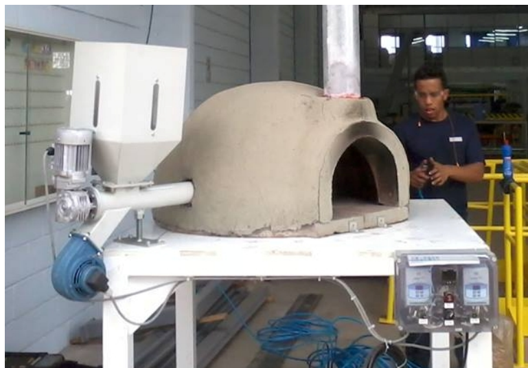
Figura 1 – Queimador a Pellet instalado em um forno de pizzaria
