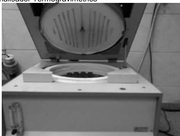
Figura 2: Amostras no analisador Termogravimétrico
