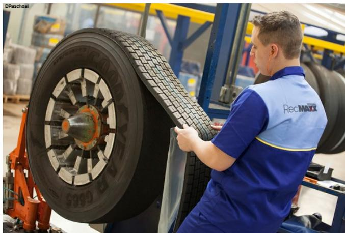
Figura 4: Pneu sendo recapado
