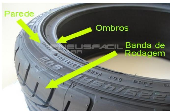
Figura 3: Pneu remoldado (“pneu remold”)
