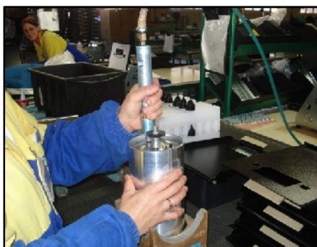
Figura 3 - Pré-montagem do cilindro
