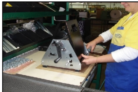
Figura 5 - Instalação das mesas suportes para alimentação e recebimento de papel.
