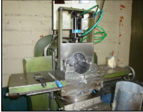
Figura 9 – Processo de fabricação da fenda para inserção da régua no duplicador a álcool
