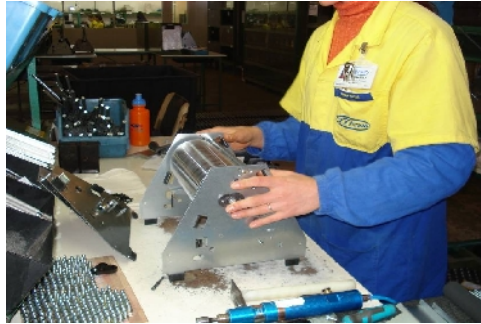
Figura 4 - Montagem do cilindro de alumínio com as laterais que estruturam o duplicador a álcool
