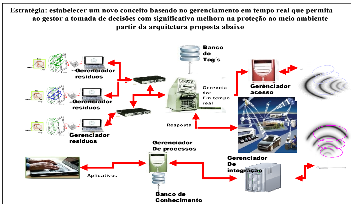
Figura 26 Arquitetura Geral do Sistema Gerenciamento com RFID da cadeia de RSS Fonte: (Elaboração do autor, 2012).
