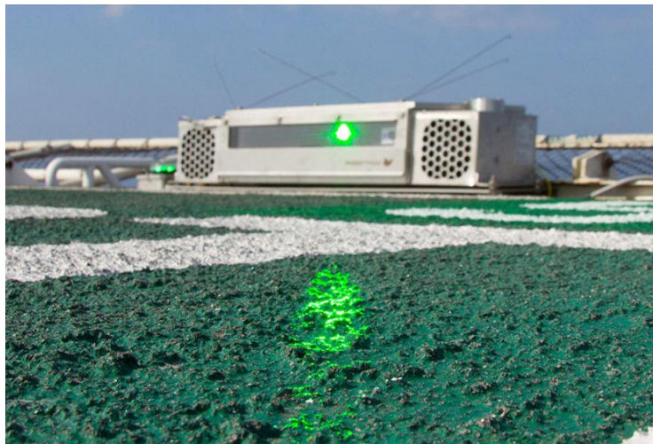
Figura 11- Laser utilizado para afugentar pássaros.
