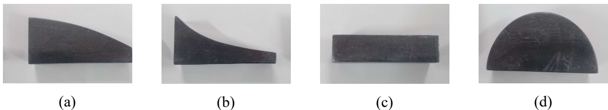
Figura 1. Perfil dos corpos de prova para análise de carga distribuída Fonte: Autor (2022)
